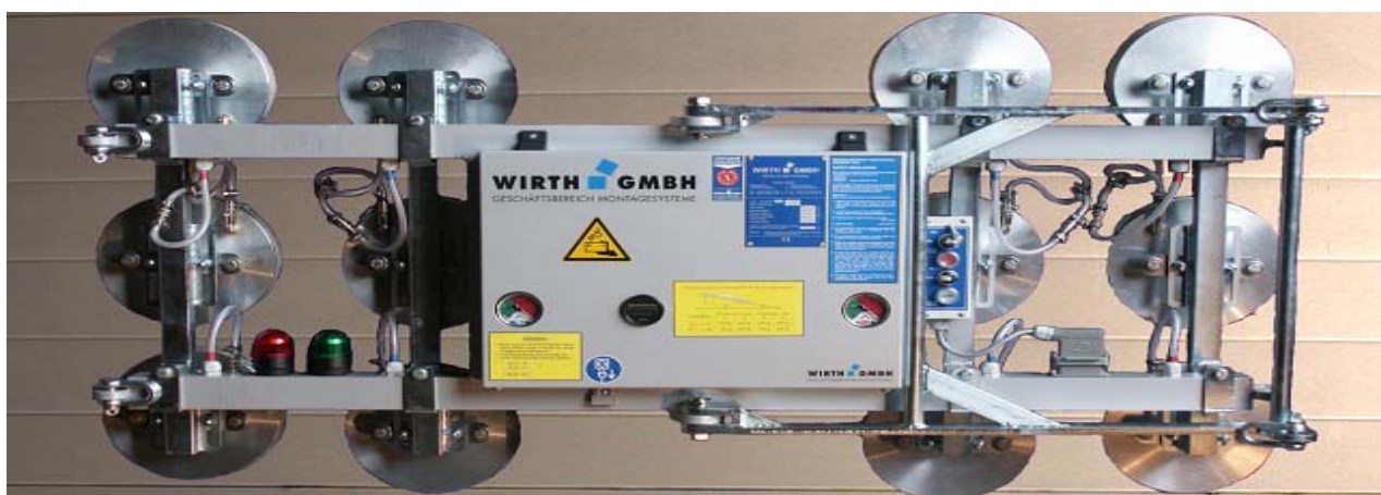
Рисунок 13б – Транспортирование и укладка стеновых и кровельных панелей на месте монтажа с помощью установочной системы Oktopus KT-V. Грузоподъёмность от 250 – 400 кг.
